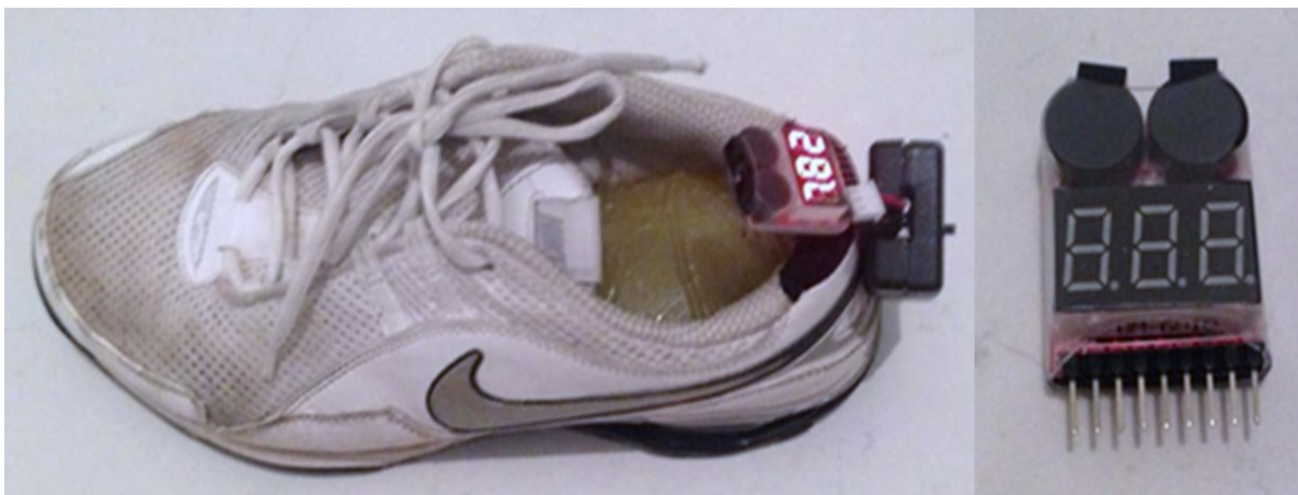
Figura 58: Verificação da carga da bateria do dispositivo / Medidor de voltagem Fonte: Elaboração própria
