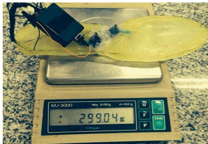
Figura 50: Massa do dispositivo - balança de precisão de 2 dígitos Fonte: Elaboração própria
