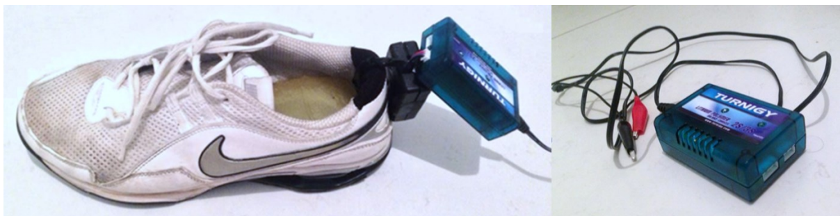
Figura 59: Processo de recarregamento da bateria / Carregador de bateria LiPo 2S Fonte: Elaboração própria
